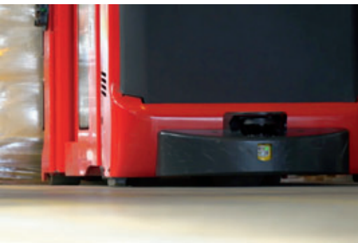
Particolare dei laser di cui è dotato il carrello
